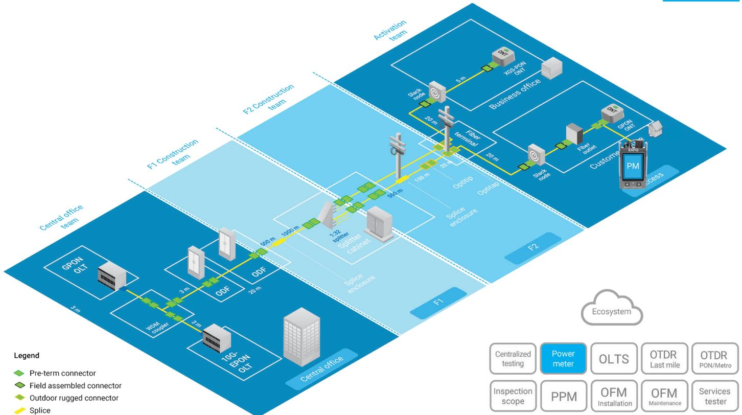
Après l'installation de la fibre et avant l'activation du service FTTH, il faut vérifier l'alimentation de la prise du terminal de réseau optique (ONT). Il faut s'assurer que la puissance est suffisante pour que l'ONT fonctionne.
