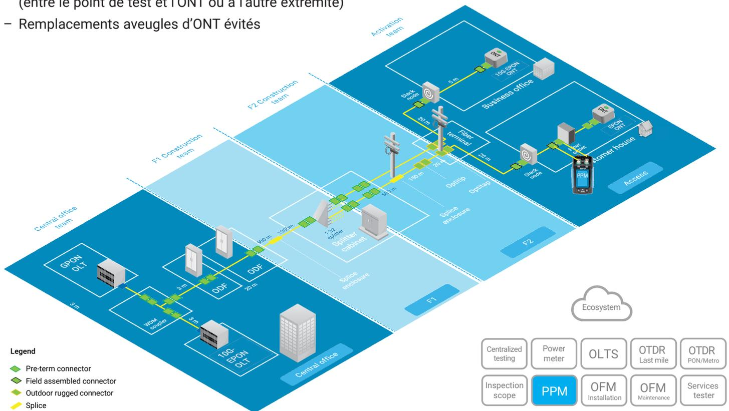
Si le même câblage de fibre optique transporte plusieurs services (p. ex., les doubles services GPON et XGS-PON), un wattmètre standard peut donner des résultats trompeurs, car il mesure la puissance totale reçue sans faire de distinction entre les différents services.
