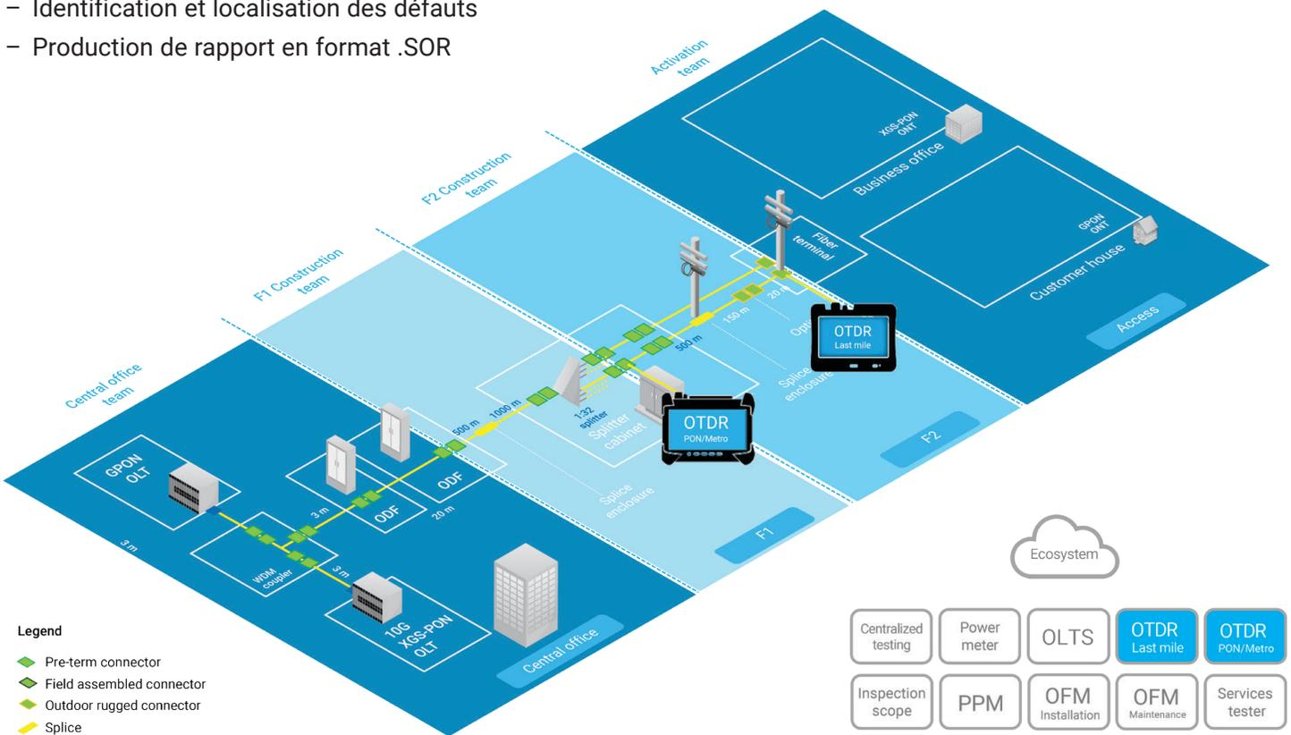
Lors du déploiement de réseau FTTH, il est essentiel de disposer des bons outils pour caractériser complètement les fibres optiques avant de passer à la phase d'installation. Il est absolument nécessaire d'utiliser un réflectomètre optique temporel (OTDR).
