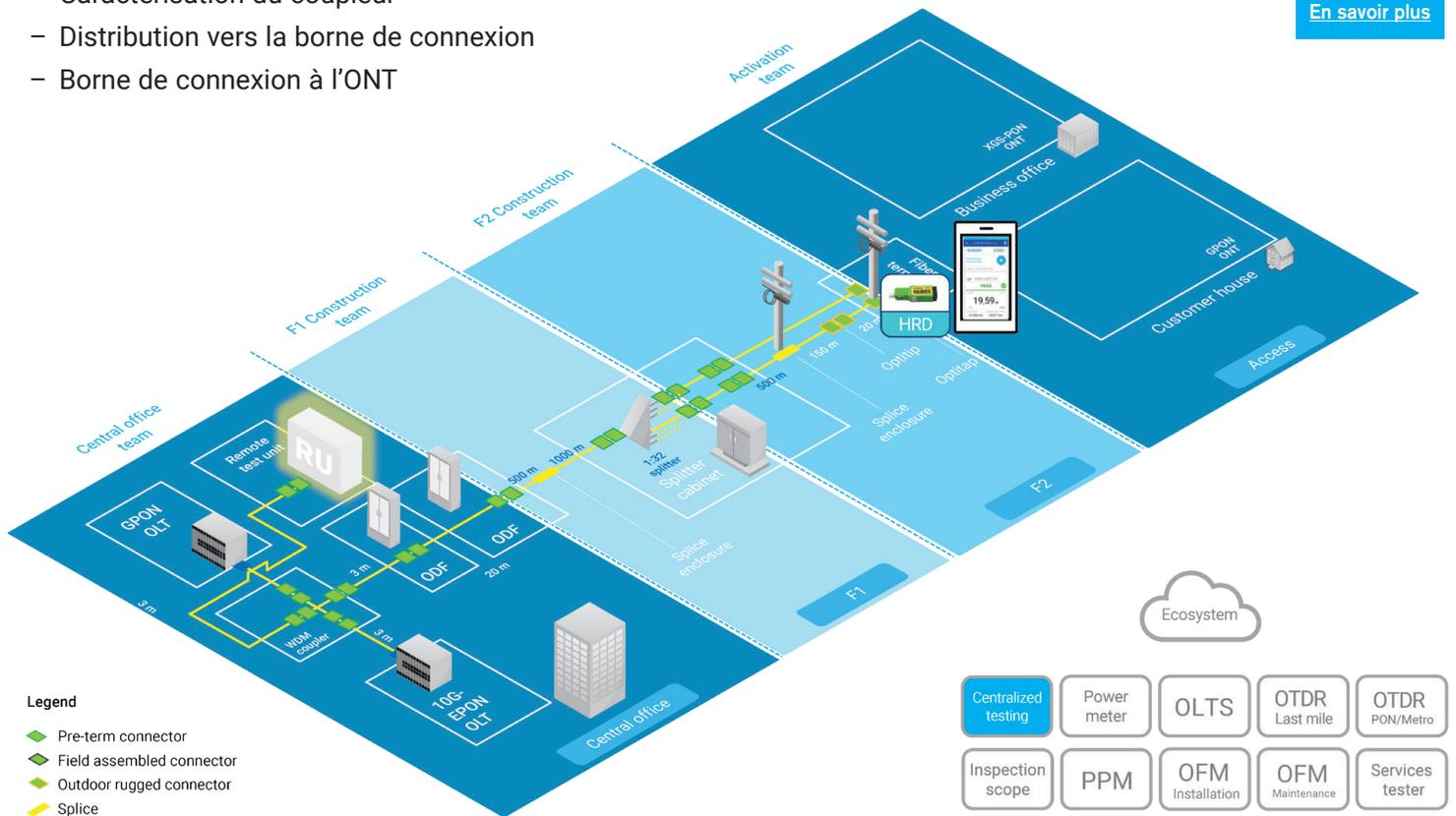
L'utilisation de testeurs portatifs sur le terrain est essentielle pour caractériser, installer et dépanner complètement la liaison optique entre les locaux du client et les OLT dans les points d'échange ou les centraux.
