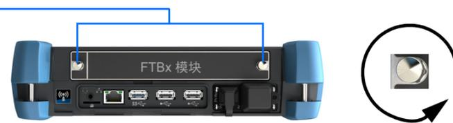
3 抓住模块两侧或固定螺丝（不能抓连接器），将其拔出。
