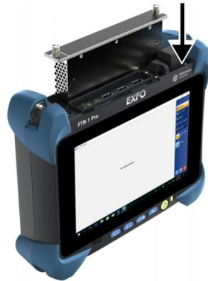
3 顺时针拧紧两颗固定螺丝，将模块固定到位。模块的面板应该与设备的前面板平齐。
