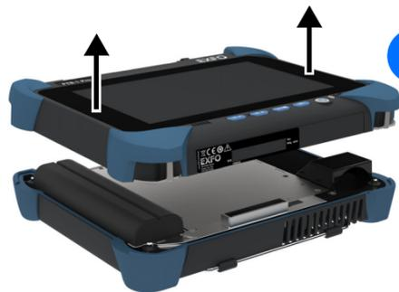
拉住电池拉手，从电池槽中取出电池。
