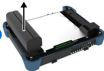
7 滑入新电池（让电池的电极朝下并与配合连接器朝向机箱同侧）。
