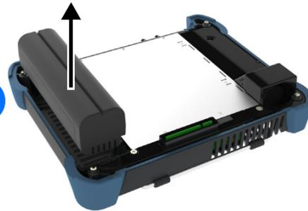
Deslize a nova bateria para dentro (com os pólos voltados para baixo e direcionados para o mesmo lado do conector de acoplamento).
