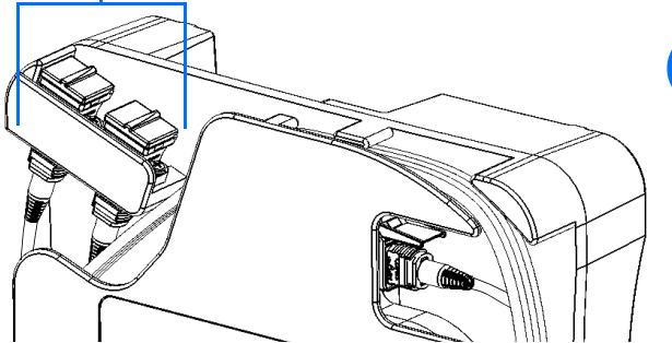
**5** 将被测设备的另一端连接到探头的可取下适配嘴。
