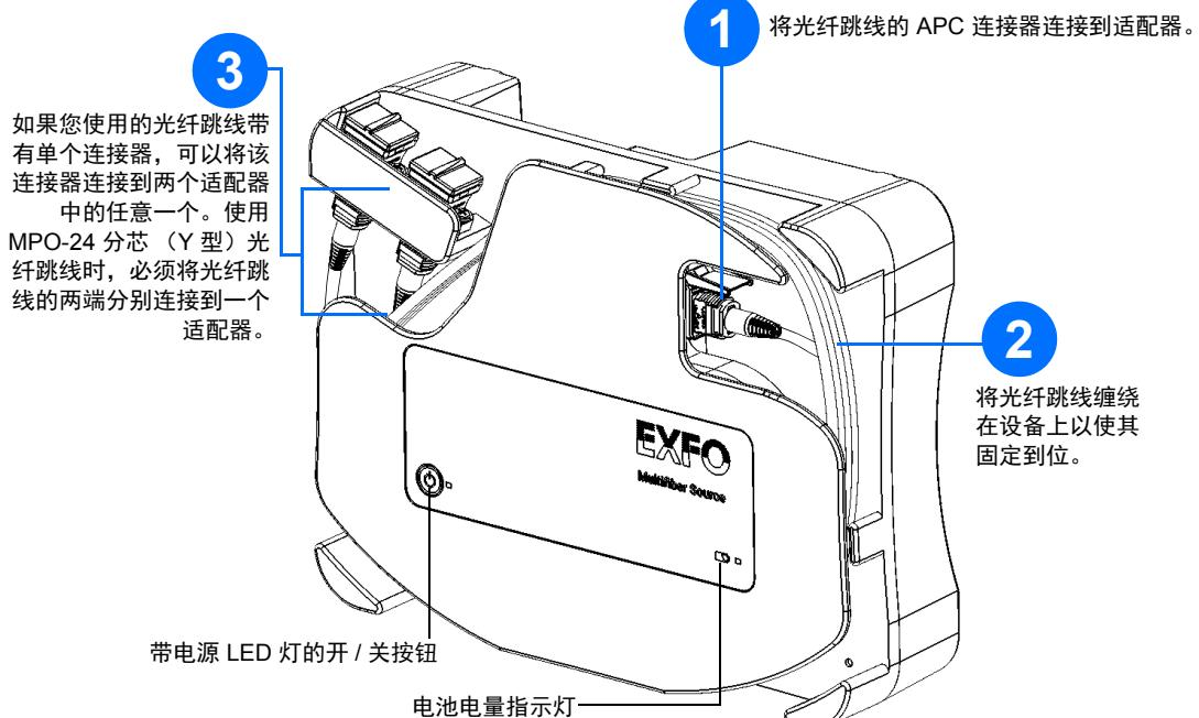
**4** 打开防尘盖，根据上一步的连接操作将被测设备连接到适当的适配器。如果连接了 MPO-24 分芯光纤跳线，必须将被测设备与两个适配器连接起来。
