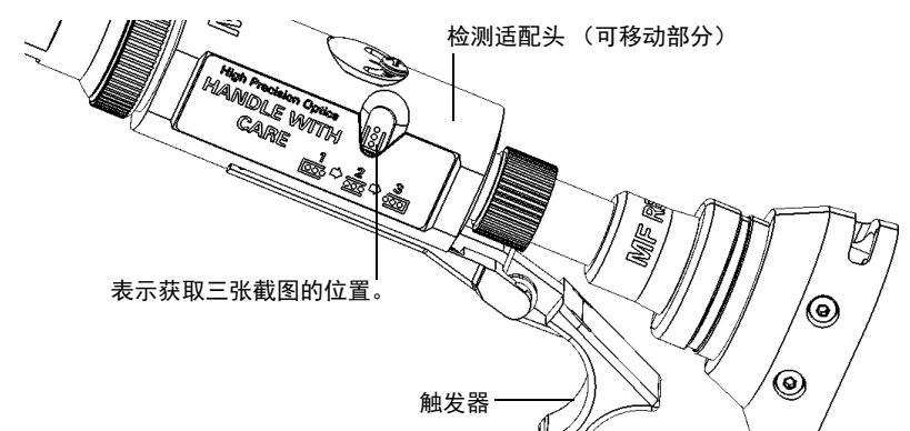
屏幕上的图标显示您何时可更改检测适配头的位置，还显示状态 LED 灯的状态。LED 灯变成蓝色并停止闪烁后，您可以执行截图。
