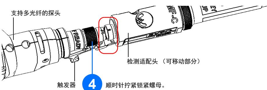
注意：如果您看不到检测适配头的凹槽，请用触发器朝适配嘴方向移动测试适配头的可移动部分。
