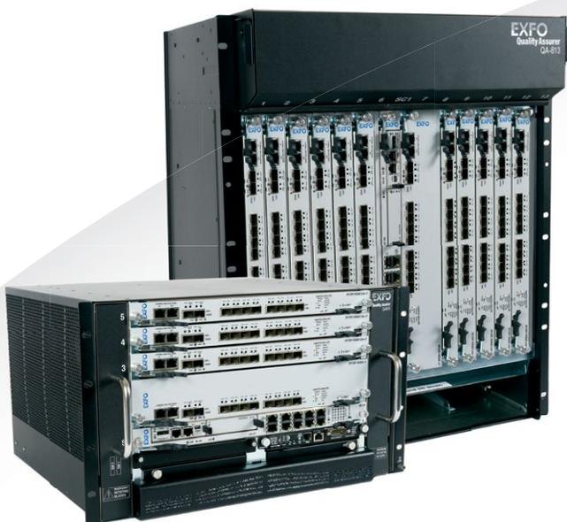
用于在实时网络状况下全面验证VoLTE性能和功能的实验室测试工具。
