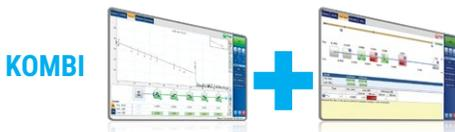
Die iOLM- und die OTDR-Anwendung werden im gleichen Gerät ausgeführt (Bestellnummer: Oi).
