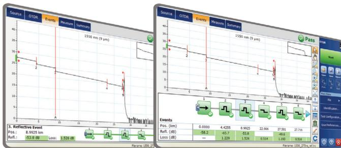
Diese verbesserte Ausführung ermöglicht dem Techniker, flexibel, sowohl die OTDR-Kurve als auch deren lineare Ansicht anzuzeigen, ohne die Messung an der Glasfaser wiederholen zu müssen.
