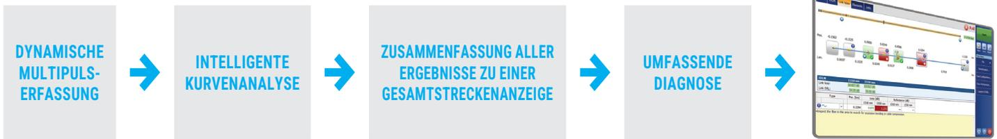
iOLM zeigt komplexe OTDR-Testergebnisse in Form von automatischen, aussagekräftigen und exakten Messergebnissen an, die allen Technikern unabhängig von der Qualifikationsstufe auf den ersten Blick alle benötigten Informationen liefern.
