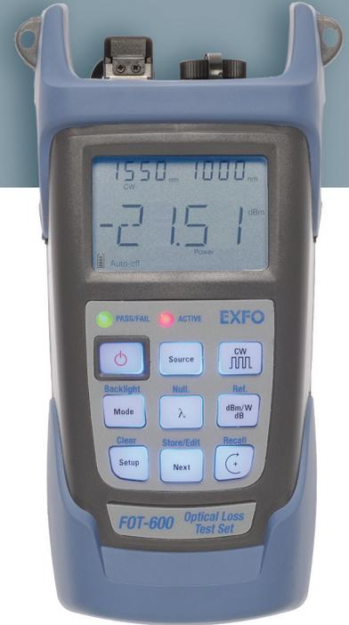
Das FOT-600 Dämpfungsmessgerät, Teil der Reihe 600 tragbarer Geräte von EXFO, zu der auch das FPM-600 Leistungsmessgerät und die FLS-600 Lichtquelle gehören, ist das ideale Instrument für die Qualifizierung von Netzwerkknoten. Die grüne/rote LED-Anzeige zeigt gemäß der vom Bediener eingestellten Grenzwerte einen erfolgreichen oder fehlgeschlagenen Test an und erleichtert damit den Feldeinsatz.
