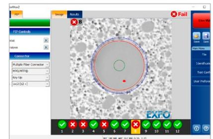
Über Ihr Mobilgerät ermöglicht ConnectorMax eine lückenlose Dokumentation der Faserendflächenprüfung. Sie haben die Möglichkeit, die Testergebnisse zu archivieren und in Sekundenschnelle aussagekräftige Berichte zu erstellen und zu teilen.
