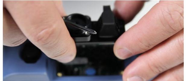
Die mühelos zu installierenden Optionen (Leistungsmessgerät/VFL-Rotlichtquelle) werden mit vier Schrauben am MAX-FIP Display befestigt.
