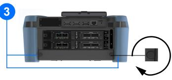
Retire la tapa del compartimento de la batería.
