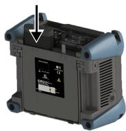
Coloque la tapa del compartimento de la batería en la unidad de forma que esté alineada con la parte superior y trasera de la misma. Si es necesario, mueva ligeramente la tapa del compartimento de la batería hasta que la alineación sea correcta.
