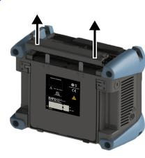
Guíese con las marcas del panel trasero para ubicar la batería que desea sustituir y, a continuación, tire de la lengüeta de la batería para liberarla de la cavidad.
