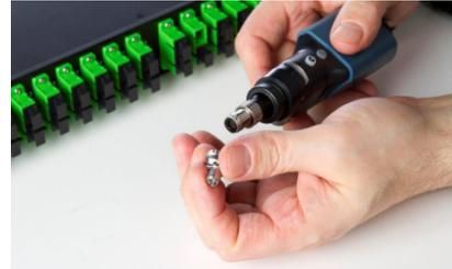
1 Connectez la pointe de l'adaptateur à la sonde FIP-400B.
