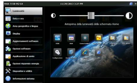
Utilizzare il cursore per regolare il livello di luminosità dello schermo.
